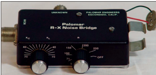
Figur 1. Støjbro fra Palomar Engineers
